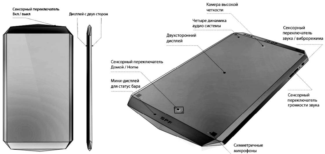
Основные конструктивные элементы смартфона
